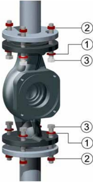
Şekil 6.3: Montajda Civata, Somun ve Rondela Sıralaması
